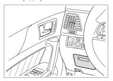
Блок предохранителей № 1 расположен внутри панели приборов на стороне водителя.
